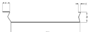
Las bandejas se pueden realizar en espesores de 0.7 mm a 1.5 mm y hasta una longitud de 6.000 mm. Existe la posibilidad de ajustar el ancho de la bandeja inicial (arranque) y final.
